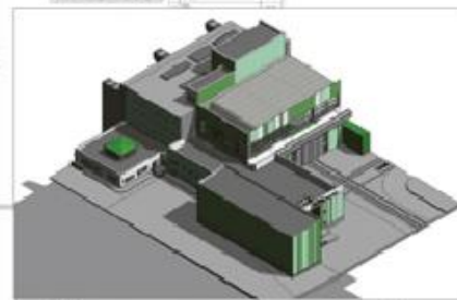
Рис. 6. Модель станционного узла, созданная по проектной документации с использованием Autodesk Revit
